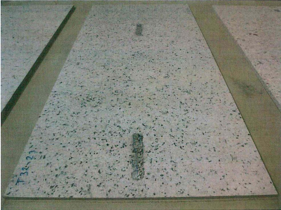
**Bild A 2.1:** Entkopplungs- und Trittschallminderungsplatte *UZIN Multimoll Top 12*
